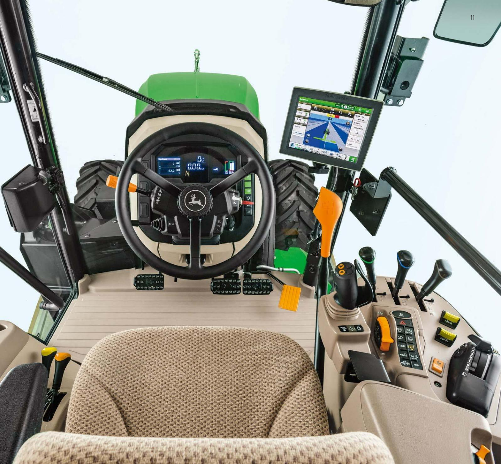
La nostra cabina Premium certificata di categoria 4 presenta un joystick elettronico e un display riconfigurabile integrato nel cruscotto per il controllo delle funzioni del trattore.
